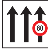
4.77.1 Anzeige von Fahrstreifen mit Beschränkungen (Beispiel)
