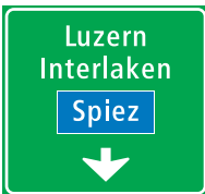
4.69 Einspurtafel über Fahrstreifen auf Autobahnen und Autostrassen
